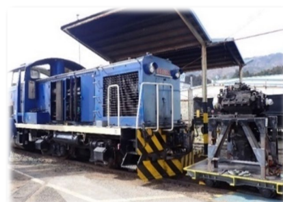
逆転機取り外し (DD5652号)
