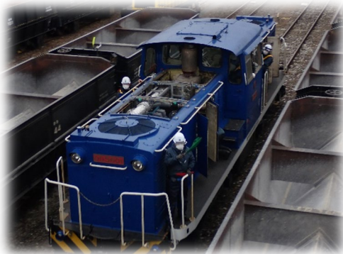
機関換装後の試運転（DD5601号）
